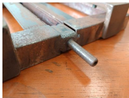
【TIG 溶接試験 TP-F 級 練習用治具】
