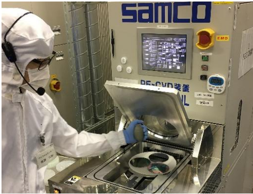
図8 酸化膜堆積 CVD
