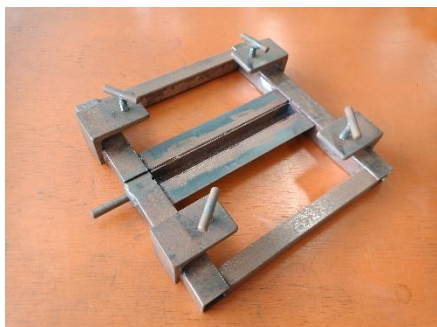
【TIG 溶接試験 TP-F 級 練習用治具】
