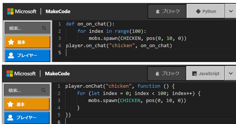
図3 図2のブロックをPython(上)とJavaScript(下)に変換したコード
