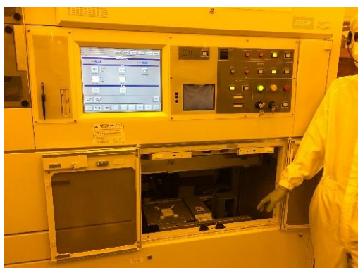
図3 フォトリソグラフィによる露光
